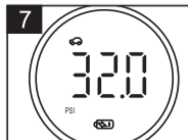
Za pomocą przycisków + i – wyreguluj ciśnienie docelowe.
